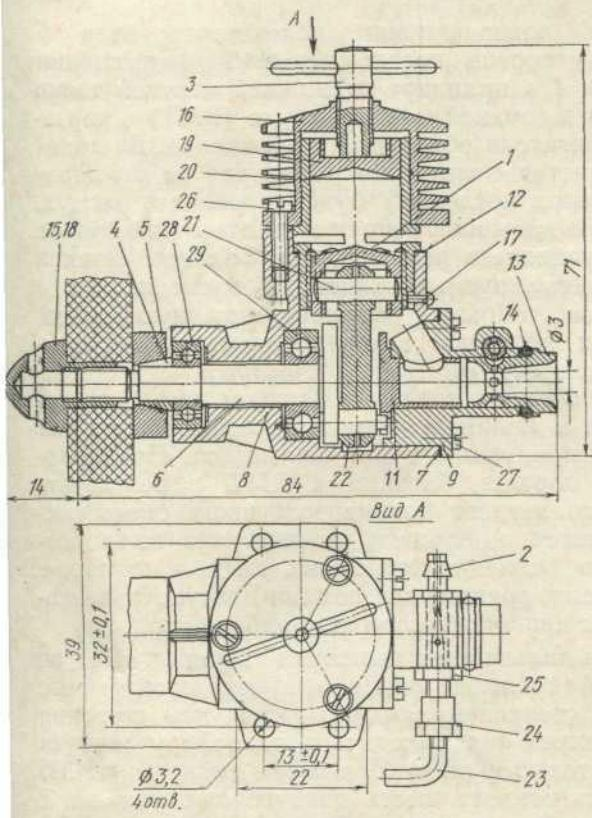
Рис. 1: 1 — поршень; 2 — поршневой пинт; 3 — жиклер; 4 — винт контровертина; 5 — конус; 6 — коленчатый вал; 7 — прокладка крышки; 8 — крышка; 9 — кольцо; 10 — уплотнительное кольцо; 11 — фуртка; 12 — прокладка гильзы; 13 — гильзы; 14 — вороток; 15 — вороток; 16 — головка цилиндра; 17 — фиксатор гильзы; 18 — шатун; 19 — винт; 20 — контпоршень; 21 — пальц поршня; 22 — шатун; 23 — игла; 24 — гайка; 25 — гильза; 26 — винт М2.5; 27 — винт М3; 28 — подшипник; 29 — подшипник задний.
